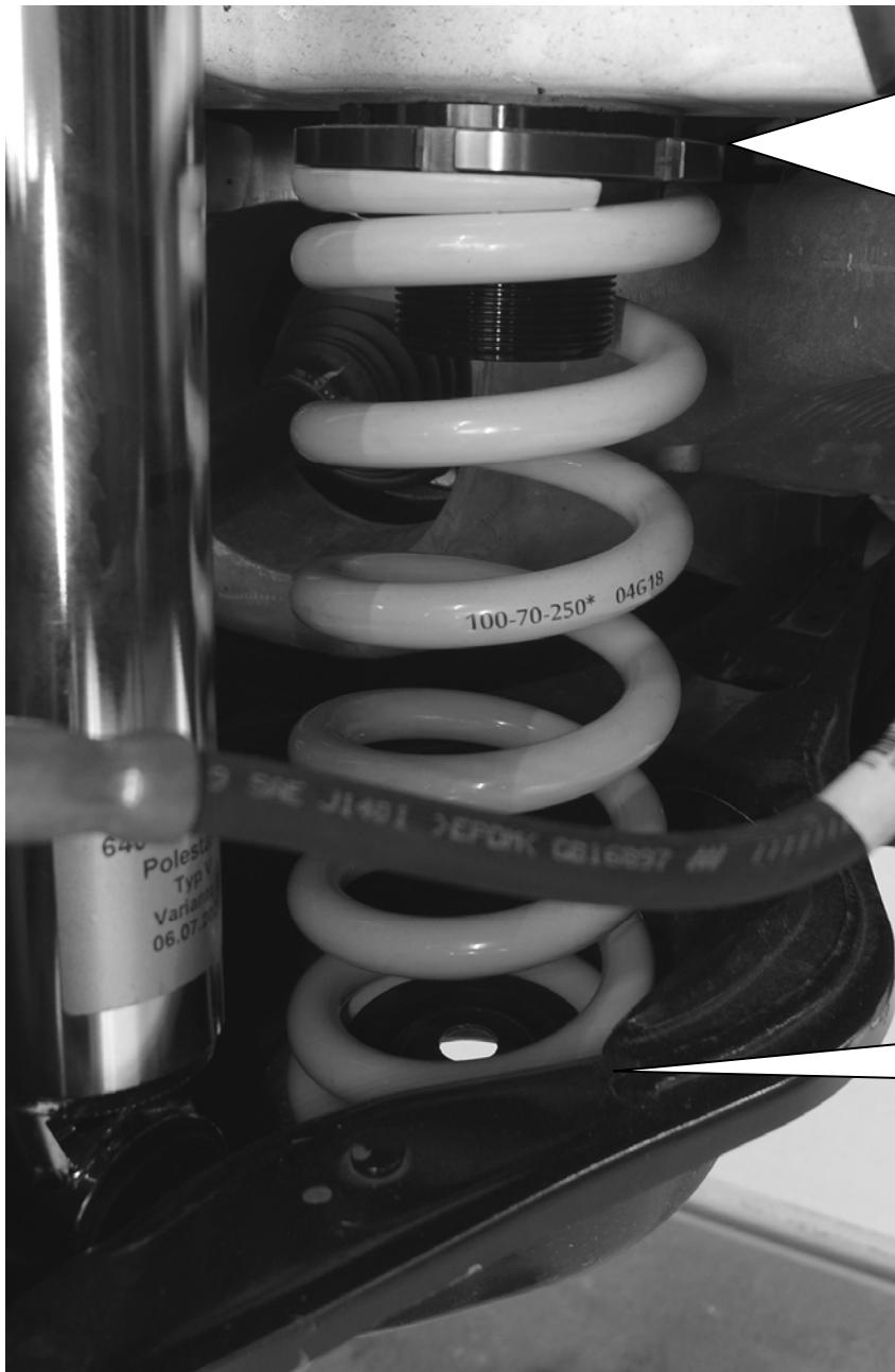
Die HA-Verstellung wird oben zwischen Feder und Karosserie montiert. Die serienmäßige Federunterlage entfällt. Zum Korrigieren (verdrehen des Gewinderings) der Fahrzeughöhe, ist die HA-Verstellung aus dem Fahrzeug zu demontieren.
