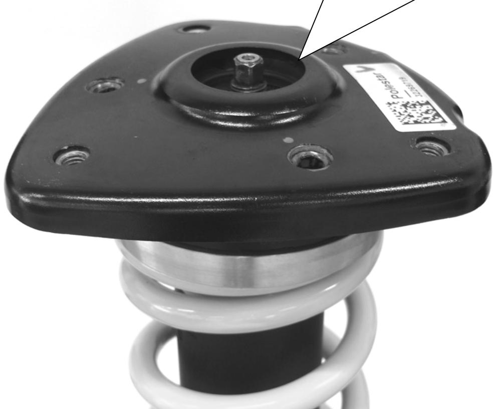
Nach erfolgtem Einbau des Fahrwerkes ist die Freigängigkeit der Bereifung zum VA-Federbein zu überprüfen. Das Mindestabstandsmaß darf an der engsten Stelle **5 mm** nicht unterschreiten und ist gegebenenfalls mittels Distanzscheiben wieder herzustellen.
