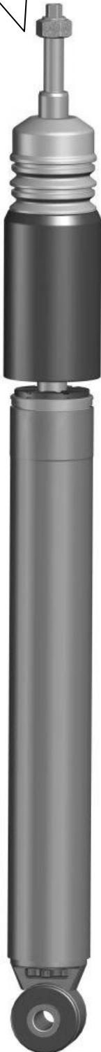
Originale Stützlagereinheit auf den Dämpfer aufsetzen und mit der mitgelieferten Mutter verschrauben. Das Anzugsdrehmoment der Kolbenstangenbefestigung beträgt 35 Nm. Die Montagehinweise zum Einbau des Dämpfers in das Fahrzeug, sowie die Anzugsdrehmomente der Befestigung, entnehmen Sie bitte den Unterlagen des Fahrzeugherstellers.
