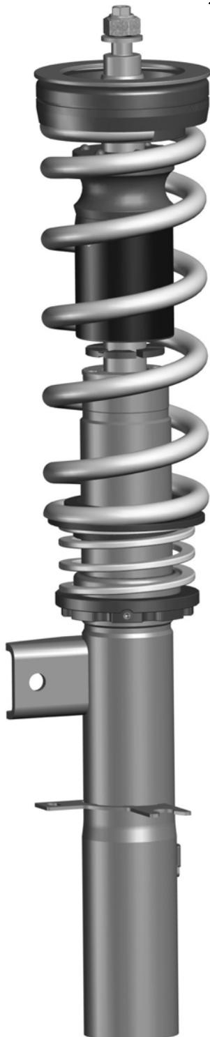
Originale Stützlagereinheit ohne Axialdrehlager auf den Federteller aufsetzen und mit der mitgelieferten Stopmutter verschrauben. Das Anzugsdrehmoment der Kolbenstangenbefestigung beträgt 35 Nm. Die Montagehinweise zum Einbau des Federbeines in das Fahrzeug, sowie die Anzugsdrehmomente der Federbeinbefestigung, entnehmen Sie bitte den Unterlagen des Fahrzeugherstellers.
