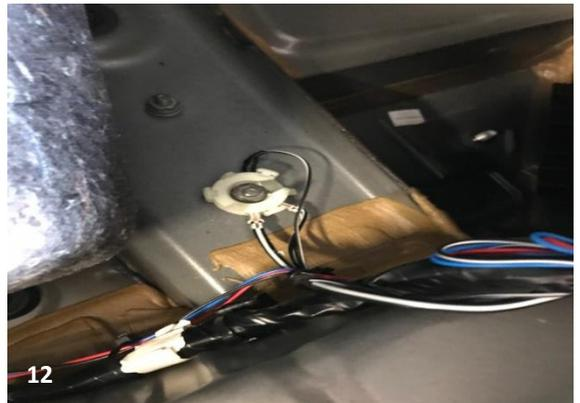
c) Anschluss des blauen Kabels am Lichtdimmer-Signalkabel
