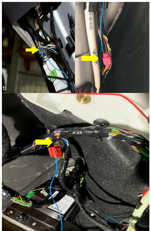
Anschluss der grün/weißen und grünen Kabel, Datensignal (OBD CAN-Bus)
