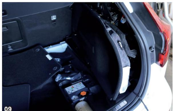
c) Folgen Sie mit dem blauen Kabel des Klappenkabelbaums dem Lichtsignalkabel entlang des originalen Kofferraumkabelbaums die D-Säule nach oben.
