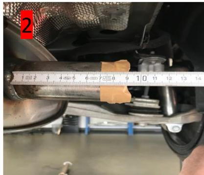
Schneiden Sie die beiden Serien Endrohrbögen ca. 70mm vom ESD gemessen ab (siehe Bild 2) / *Cut the two series tail pipe bends off approx. 70mm measured from the silencer (picture 2).*
