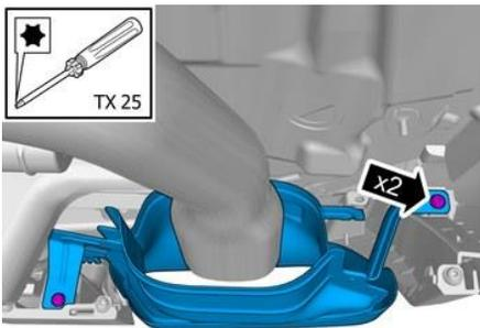
Entfernen Sie die beiden TX25 Schrauben und tauschen das Serien Endrohr gegen das HEICO Endrohr / *Remove the two TX25 screws and replace the standard tailpipe with the HEICO tailpipe.*
