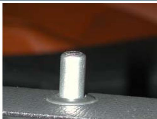
Schrauben Sie die HEICO Türpins in der gleicher Weise wieder auf die Gewindestange bis ein deutlicher Widerstand zu spüren ist. Es kann sein dass es einige Umdrehungen dauert bis sich das Gewinde in den Pin zu schneiden beginnt. Anschließend richten Sie das HEICO- Logo aus.
