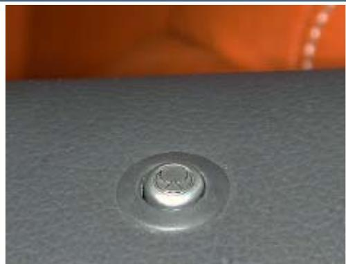
Nach dem Sie alle Türpins montiert haben, verriegeln Sie die Türen und überprüfen Sie ob alle Pins gleich tief in die Türverkleidung eintauchen. Gegebenenfalls stellen Sie abweichende Pins ein durch herein- oder herausdrehen.
