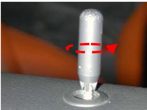
Die originalen Türpins herausdrehen. Verwenden Sie unterstützend eine Zange falls die Türpins sehr fest sitzen sollten. Achten Sie darauf die Gewindestange der Türpins nach der Demontage nicht in die Türverkleidung zu drücken.
