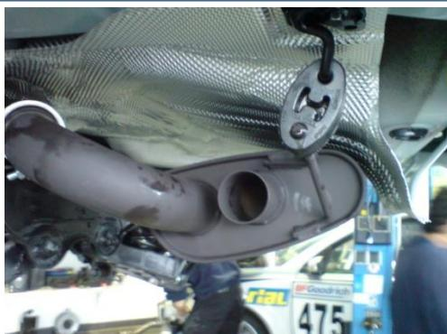
Entgraten Sie die Schnittkante nach dem Abschneiden und schieben Sie das Anschlussrohr, inklusive der Schelle, des HEICO SPORTIV Endschalldämpfers auf das abgeschnittene Rohr. **Ziehen Sie die Schelle zum vorderen Rohr noch nicht fest!!!!**
