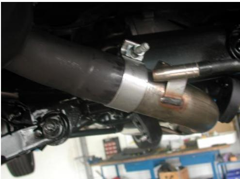
Führen Sie eine Probefahrt durch und kontrollieren Sie die Positionen der Endrohre und die des Endschalldämpfers. Danach ist zur Sicherung ist in der Nähe der Schellen ein Schweißpunkt anzubringen, ebenso an den Endrohren!
