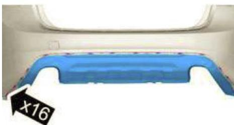
Nun sind die 16 Klipse des Heckschürzeneinsatzes zu entriegeln. Verwenden Sie hierzu einen Kunststoff- Keil um die Klipse aus den Verankerungen zu lösen. Anschließend können Sie den Heckschürzeneinsatz vorsichtig heraus ziehen und, falls vorhanden, die Stecker der PDC Sensoren entfernen. Entfernen Sie anschließend auch die PDC Sensoren und übergeben diese ggf. der Lackiererei.
