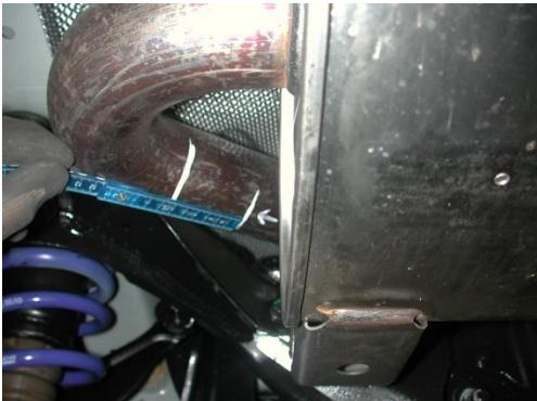
Demontieren Sie die originalen Endschalldämpfer. Die Schnittkante ist 60 mm vom Rohrbogen über der Hinterachse in Richtung Vorne.
