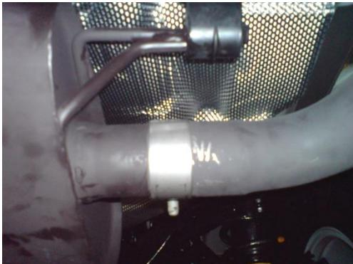
Hängen Sie den Enschalldämpfer in die Gummilager ein. Montieren Sie anschließend die Rohrbögen mit den Endrohren und der Schellen. Richten Sie die Endrohre an der Heckschürze aus und ziehen Sie alle Schellen anschließend fest. **Ziehen Sie die Schelle zum vorderen Rohr der originalen Abgasanlage als letzte fest. Zuvor bitte vergewissern dass die Endrohre zur Heckschürze ausgerichtet sind.**
