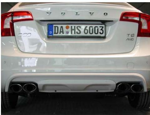
Anschließend ist der, zuvor lackierte, HEICO SPORTIV Heckdiffusor in die originale Heckschürze zu verklippen. Vergewissern Sie sich, dass alle Klipse richtig einrasten und die PDC Sensoren montiert sind. Abschließend werden die beiden unteren Schrauben oder Klipse, welche in Schritt 1 entfernt wurden, wieder befestigt.
