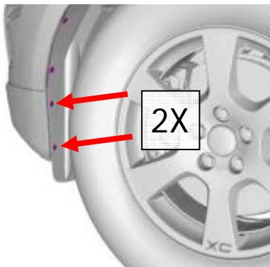
Heben Sie das Fahrzeug mit einer Hebebühne auf Arbeitshöhe an. Entfernen Sie die beiden unteren Schrauben im Radhauskasten jeweils Links und Rechts am Fahrzeug.
