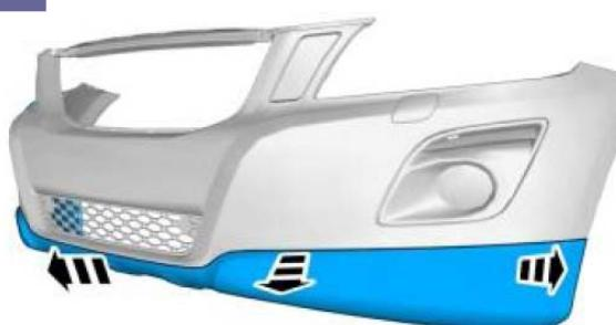
Anschließend ist der originale Frontspoiler heraus zu ziehen. Verwenden Sie hierzu einen Kunststoffkeil um die Clipse aus den Verankerungen zu lösen.
