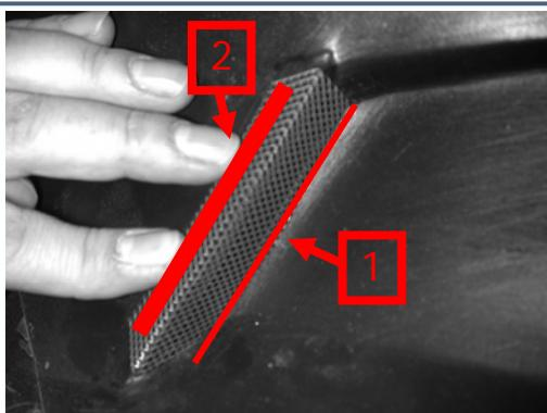
Montieren Sie die mitgelieferten Gitter in den zuvor lackierten HEICO SPORTIV Frontspoiler. Schieben Sie das Gitter vor den Steg (1). Tragen Sie den mitgelieferten Klebstoff auf der oben liegenden Fläche (2) auf. Nun muss der Klebstoff 12 Stunden bei 20°C aushärten. Installieren Sie die PDC- Sensoren in die Halter, falls vorhanden.
