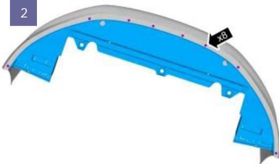
Nun sind alle 8 Schrauben unter der Frontschürze zu entfernen.
