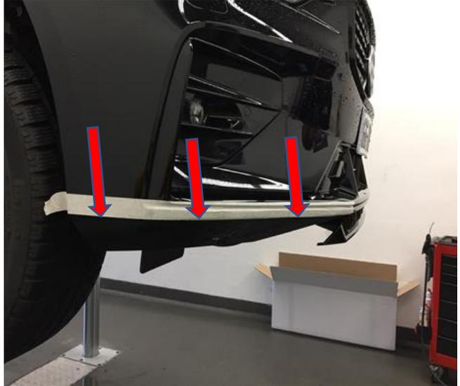
Beim verkleben von der Mitte aus beginnen um dem exaktem Verlauf der Frontschürze folgen zu können. Die Anbindung zum Mittelteil und zur Radhauskante muss gewährleistet sein.
