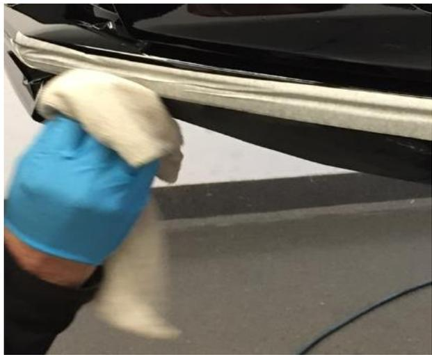
Entfernen Sie nun einen Teil des Schutzfilms der Klebestreifen. Tun Sie dies unter keinen Umständen ohne Handschuhe, da andernfalls das Klebeband, durch das Fett auf der Haut, eventuell nicht ausreichend Haftung aufbauen kann. Zur Hilfe beim Entfernen kann die Spitze einer Teppichmesser-Klinge verwendet werden.
