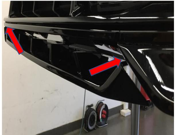
Die Frontflaps, mit den mitgelieferten Schrauben/Hülsen, von unten an der Frontschürze befestigen.
