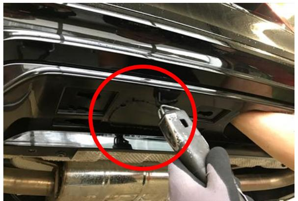
Die Kante 1 reinigen und den, mitgelieferten Kleber, entlang der Kante auftragen.
