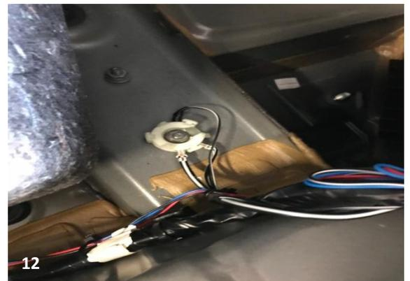
c) Anschluss des blauen Kabels am Lichtdimmer-Signalkabel
