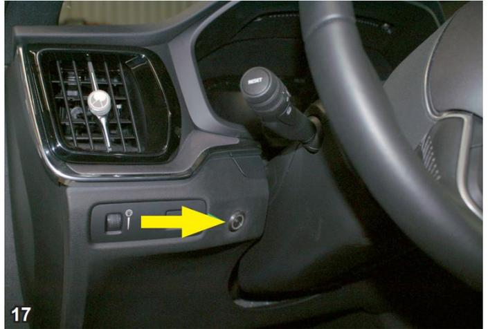
*Bohren Sie das Loch mit einem Bohrer (ca. Ø 5,0 mm) vor und anschließend mit einem Bohrer auf Ø 19 mm. Stecken Sie den Aktivierungsschalter in das gebohrte Loch und schrauben diesen mit der Überwurfmutter fest.*
