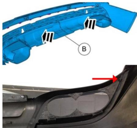
Es wird empfohlen, die HEICO Heckschürze auf der nicht sichtbaren Seite an den Rastnasen zusätzlich mit der originalen Heckschürze zu verbinden, beispielsweise mittels Polsterklammern. /
