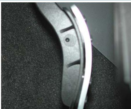
Überprüfen Sie den korrekten Sitz der Alu- Pedale auf originalen Pedalen. Die Alu- Pedale müssen „plan“ aufliegen und dürfen nicht durch die Verschraubung verspannt sein.
