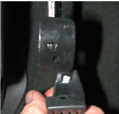
Falls vorhanden entfernen Sie auch das Pedalgummi von dem Pedal der Feststellbremse und orientieren Sie sich an Punkt 4 zur Montage.
