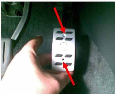
Halten Sie nun das Alu- Pedal auf das originale Gaspedal in einer waagrechten Position und markieren Sie mit einem Stift die Position der Löcher. Danach entnehmen Sie das Alu- Pedal wieder und bohren die Löcher mit einem 2 mm Bohrer vor. Montieren Sie nun die Pedale mit den mitgelieferten selbstschneidenden Schrauben.
