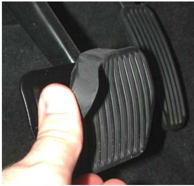
Lösen Sie das Pedalgummi vom Bremspedal (und Kupplungspedal beim Schaltgetriebe).
