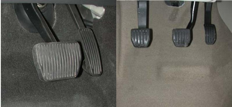
Serienmäßige Pedalerie von Automatik- und Schaltgetriebe.
