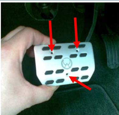
Halten Sie nun das Alu- Pedal auf das originale Bremspedal (sowie Kupplungspedal) in einer waagrechten Position und markieren Sie mit einem Stift die Position der Löcher. Danach entnehmen Sie das Alu- Pedal wieder und bohren die Löcher mit einem 3,5 mm Bohrer. Es ist hilfreich einen Körner zu verwenden, da das Material sehr hart ist. Im Anschluss entgraten Sie die Löcher um montieren dann die Pedale mit den mitgelieferten Schrauben.
