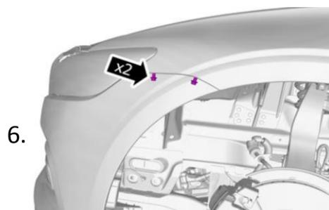
Die Schrauben entfernen und den Clips lösen.
